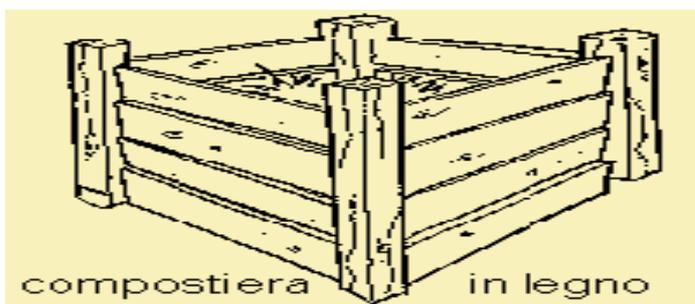
Cassa compostiera, utilizzando reti o assi in funzione di contenimento, avendo cura di consentire una buona areazione interna.
